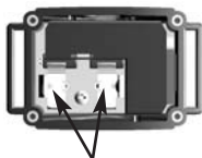
Reset : poner en contacto los dos ganchos de la pila - Fig. 11
